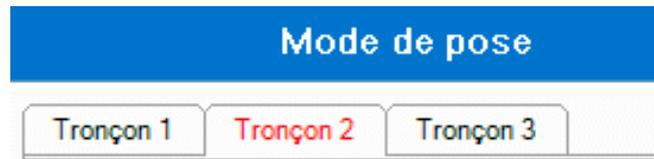
Si le mode de pose d'un tronçon est incompatible avec le type de câble utilisé, il est affiché en écriture blanche sur fond rouge et il n'est pas possible de valider la fenêtre :
