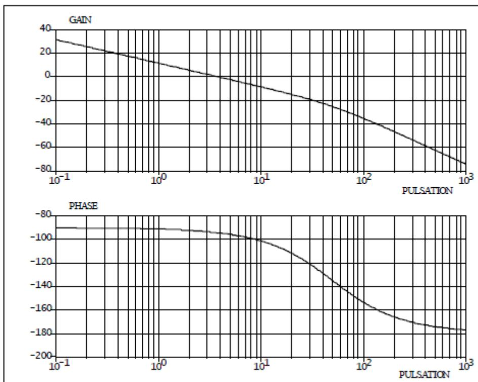
Sur la figure ci-dessous est représentée l'entrée  $\epsilon(t)$  en fonction du temps. Déduire à partir des courbes de gain et de phase l'amplitude et la phase du signal  $U_s(t)$  par rapport à  $\epsilon(t)$ .
