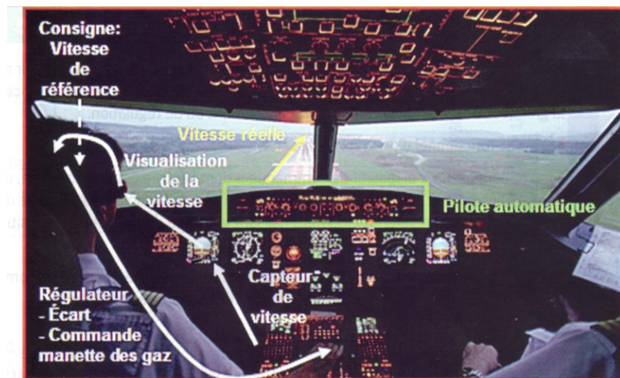
Asservissement manuel de la vitesse et utilisation du pilote automatique de l'A320
