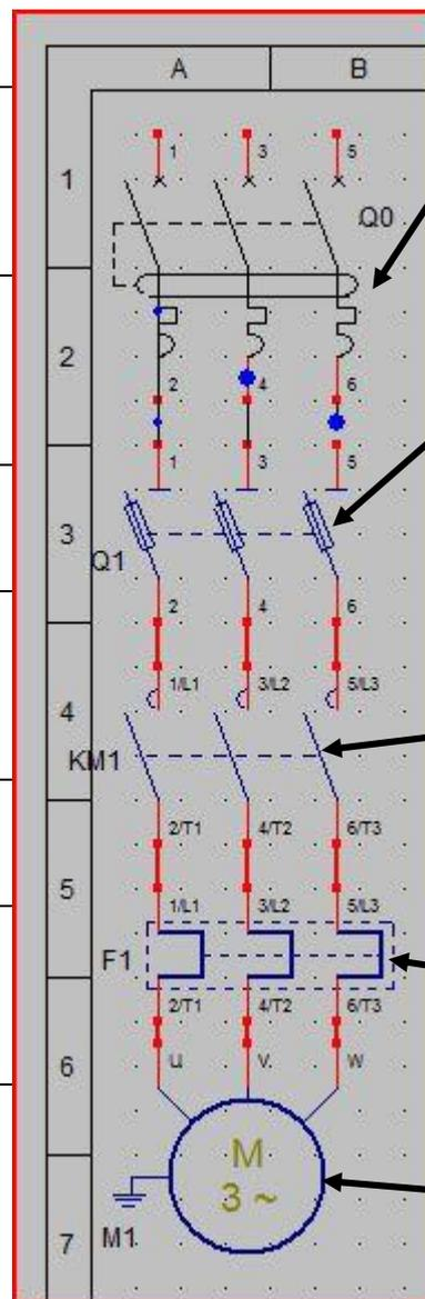
**Disjoncteur magnéto-thermique différentiel**
