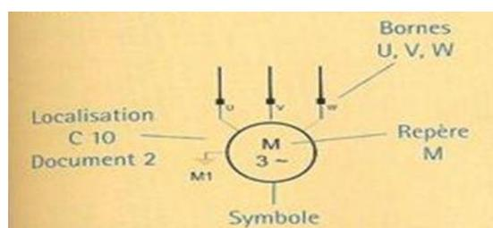
Les liaisons électriques entre les composants sont des traits continus. Les liaisons mécaniques entre les composants sont des traits discontinus. Les circuits des chaînes de puissance et d'information sont séparés fonctionnellement et souvent électriquement.
